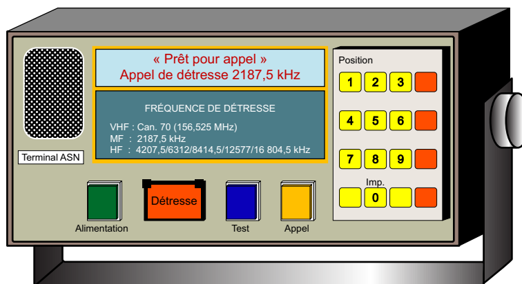
1.2.4.4. — Exemple d'unité de commande embarquée, munie du dispositif ASN.
