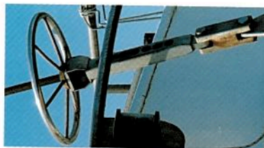
Bien que passés de mode, les ridoirs à volant conservent une redoutable efficacité.
