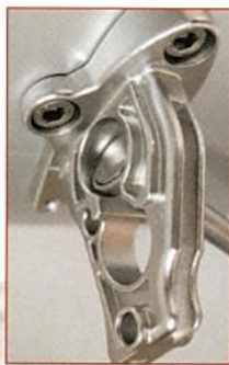
L'intégration des embouts à boules, pour le gréement monofil, se fait dans les embases de barres de flèche.
