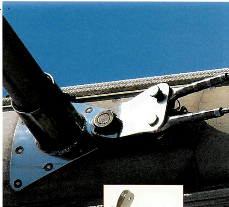
Même si elles datent, les lattes de capelage sont d'une fiabilité exemplaire.
