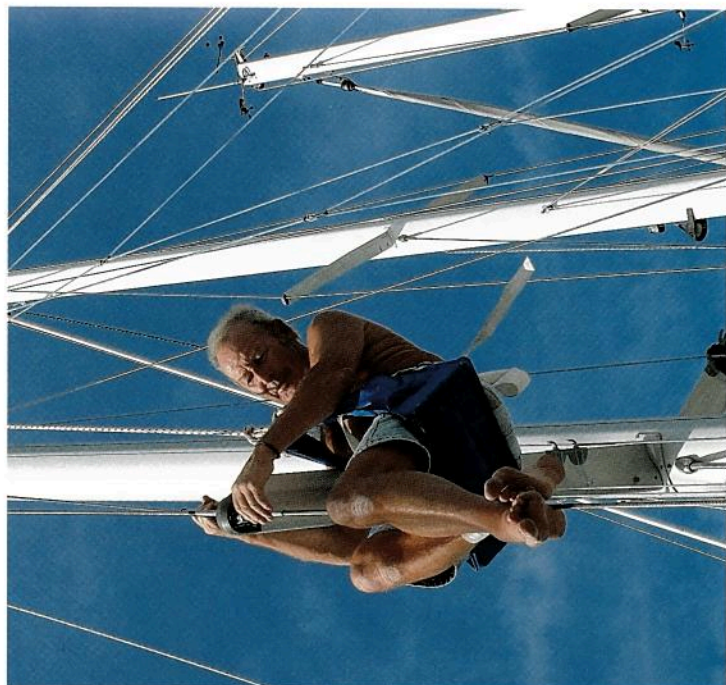
Une inspection régulière du gréement est nécessaire car toutes les pièces d'accastillage ne travaillent ni ne vieillissent de la même façon.
