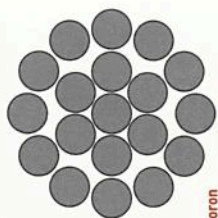
Dyform Ce câble essaie de remplir l'espace au maximum, et donc limite son allongement.
