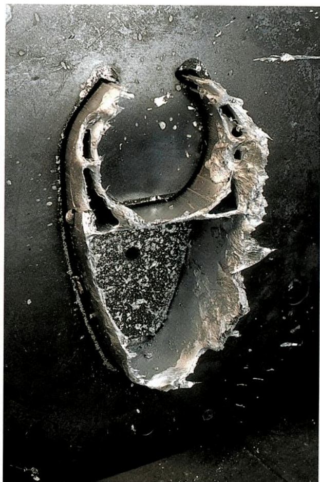
Le bloc d'aluminium à la sortie de la filière.
