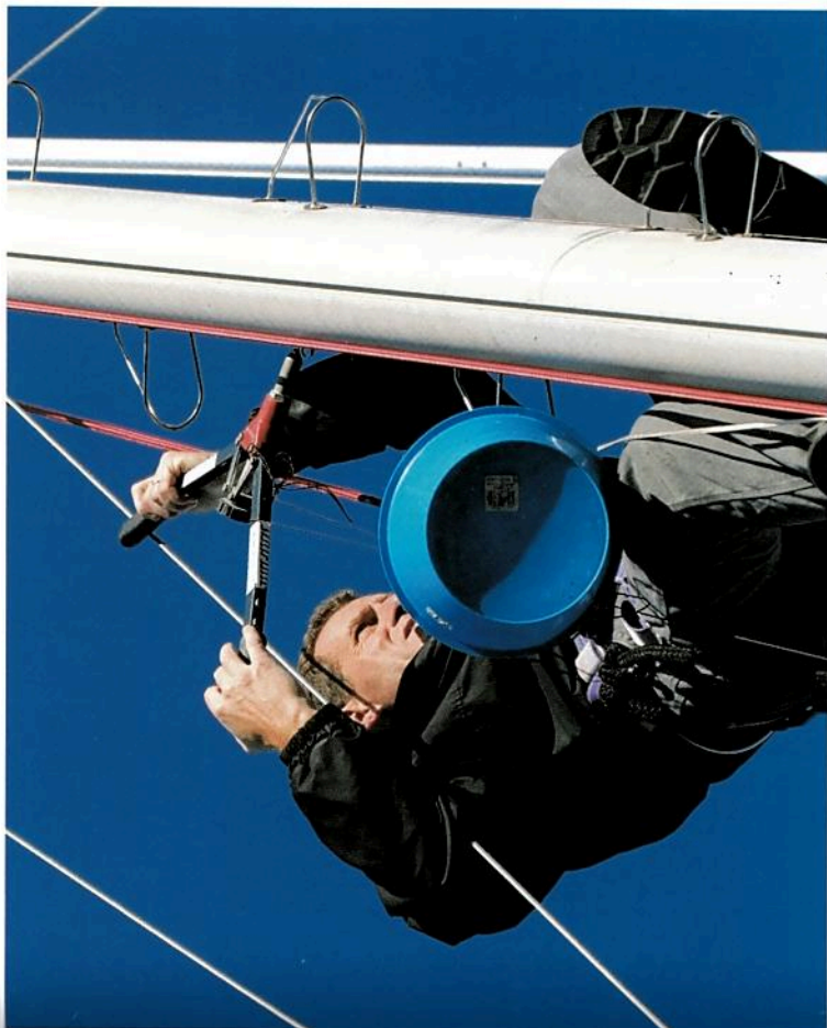
Le rivetage à l'aide d'une « popeuse » est un moyen rapide et sûr pour fixer des pièces sur le mât (ici des marches). Mais, à la main, on ne peut fixer que des rivets en aluminium.
