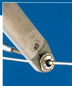
Les embouts de barres de flèche d'un gréement monofil s'appellent Tip Cup et permettent d'axer le rod dans tous les sens.
