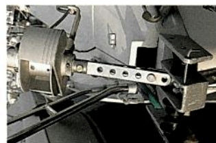
Les axes et les lattes à trous qui fixent l'étai sont sujets à torsion et à chocs : une inspection régulière s'impose.
