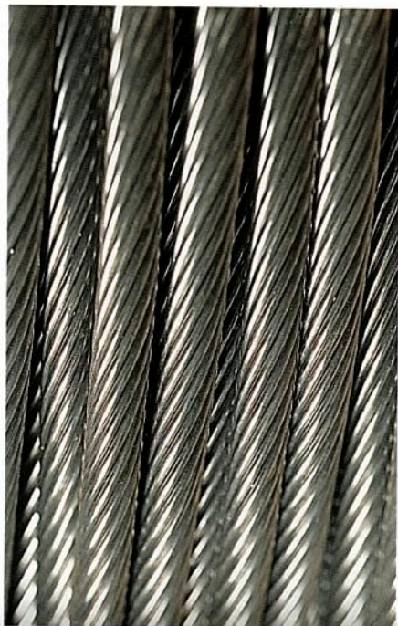
Un monotoron est constitué de 19 fils d'acier savamment toronnés.
