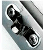
Isolez l'accastillage du mât avec un joint élastomère.
