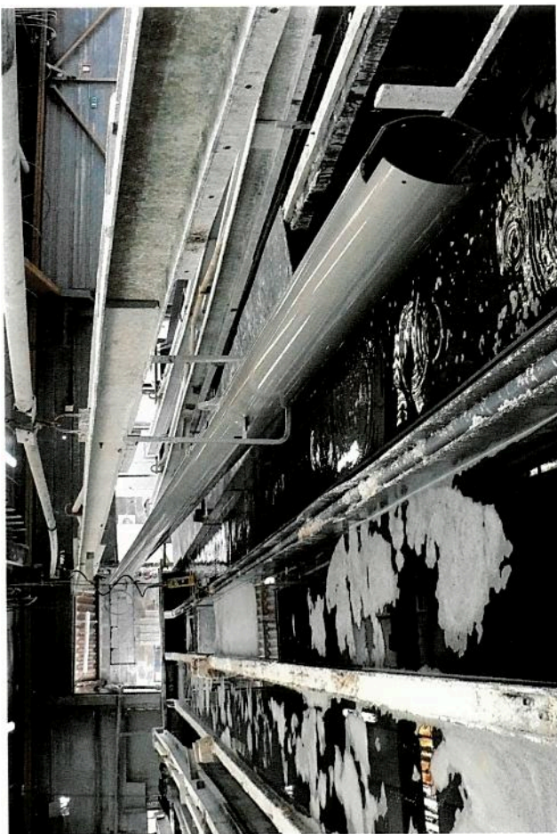
Le bain de rinçage après anodisation chez Z-Spars. Le mât a été « machiné » à la commande numérique et donc préperce avant anodisation. Les bains ne dégagent aucune odeur...
