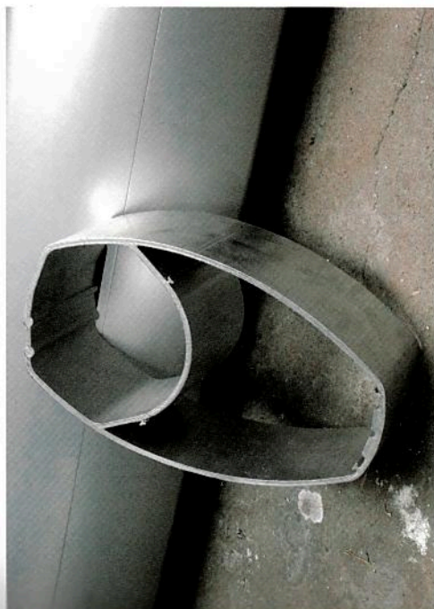
La section d'un mât à enrrouleur possède une partie isolée pour la voile.
