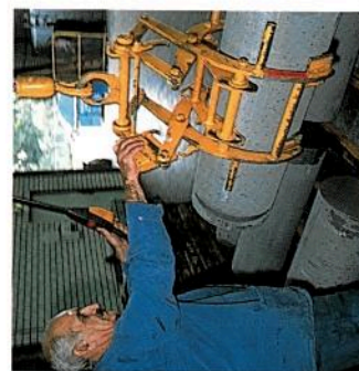
Ces blocs d'aluminium, appelés « billettes », constituent la matière première. Ils sont préalablement chauffés avant d'être introduits dans la filière.
