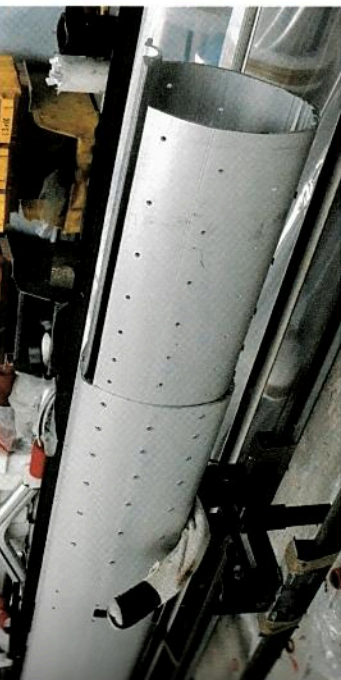
Un manchon est une pièce spéciale et non un bout de mât retailé.
