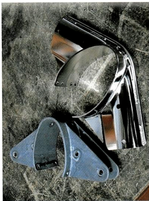
Il existe des embases de barre de flèche en alu moulé ou en inox, celles-ci étant notamment prisées par les voiliers sportifs.
