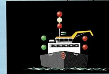
Navire procédant à des travaux sous-marins. Tous les bateaux doivent passer sur son « côté vert ».
