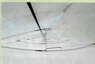
Les cerceaux raidissant le bord d'attaque de l'aile et définissant son profil viennent en appui sur la face avant du mât.
