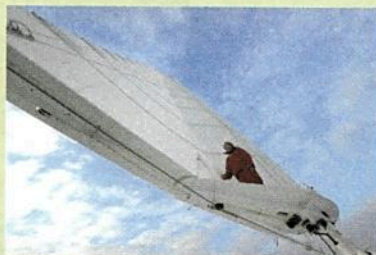
A bord du Sense 43. L'arrière du profil est une membrane fine, c'est l'articulation du balestron qui confère à l'aile sa cambrure.
