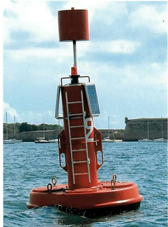
Les nouvelles bouées modulaires sont maintenant équipées de batteries et de panneaux solaires.
