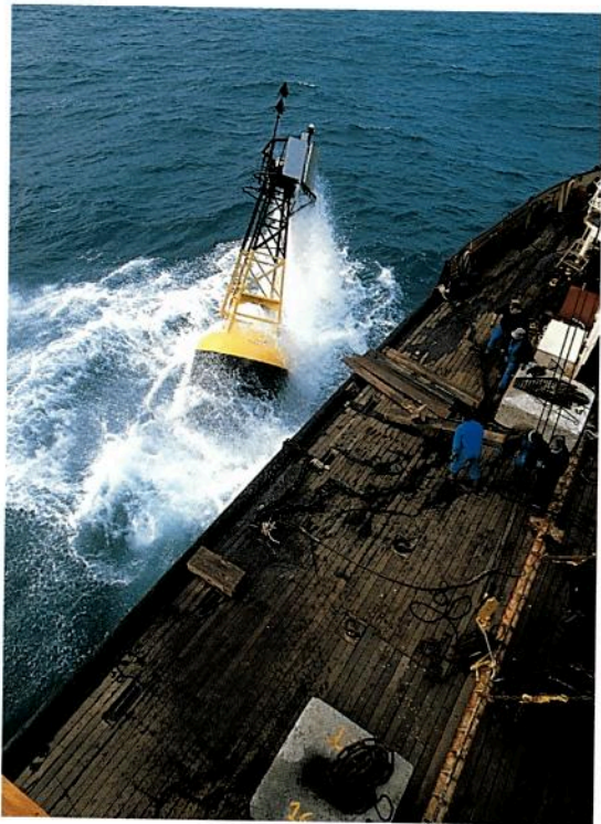
Mise à l'eau dans le chenal du Four, depuis le pont du baliseur Georges de Joly, d'une bouée fraîchement repeinte.
