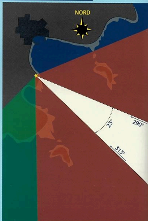
Les secteurs d'un feu sont toujours définis par relèvements à la mer. Les limites de ce secteur blanc de 23^\circ sont les relèvements du phare au 290^\circ et au 313^\circ .
