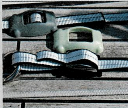
Cette boucle inox est conçue pour que l'on puisse replier le dormant par-dessus, vers la cadène.
