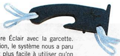
À gauche, la sangle cousue sur la bordure, qui permet d'étaquer la voile par le bas; ci-dessus le crochet qui vient se prendre dans la boucle en haut de la voile, sur la chute (ci-contre), guidé par la fermeture Éclair. Les deux boucles sur le crochet servent à fixer une drisse (à gauche) pour étaquer par le haut, et une gârcette (à droite) pour redescendre le crochet.
