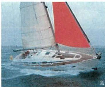
La Gale Sail d'ATN, une voile à fourreau plutôt bien conçue, qui est une alternative au Storm Bag de Delta Voiles.
