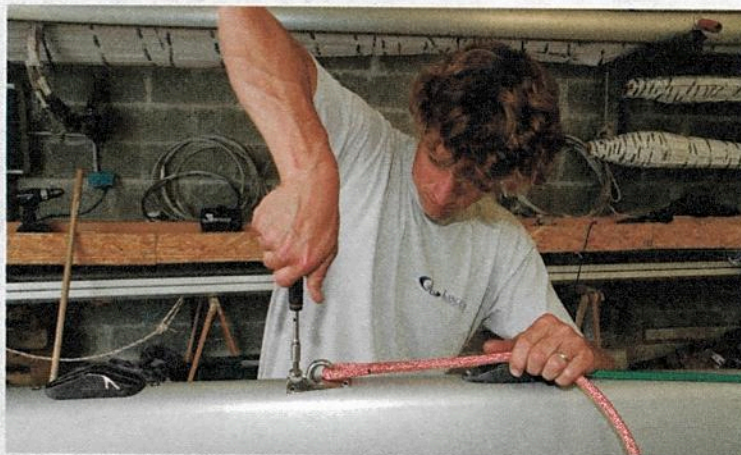
Installation d'un étai largable sur un mât de Malango, chez Cornouaille Gréement, à Concarneau.
