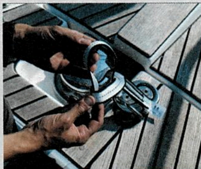
Chaque sangle se termine par une boucle, ce qui permet de les frapper très facilement sur une cadène à l'avant.
