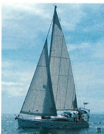
À gauche le génois Vortex entièrement déployé, à droite le même partiellement roulé; la surface enroulée ici est développable, ce qui évite les plis et permet de conserver une bonne tension de guindant.
