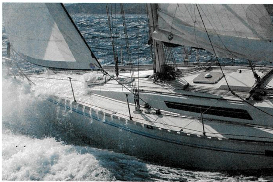
Quand on enroule un peu, ou beaucoup, de génois, il faut penser à avancer les chariots d'écoute. On peut ensuite les reculer un peu afin de réduire la puissance de la voile en vrillant celle-ci davantage.
