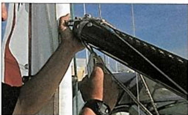
Pour manipuler aisément le tangon : une poignée en sangle à chaque bout.
