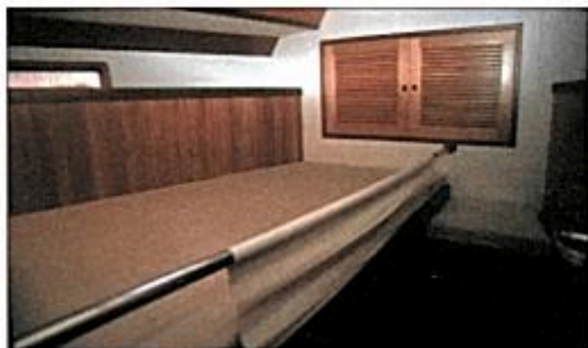
Les tubes de ces toiles antiroulis sont esthétiques mais peu confortables.
