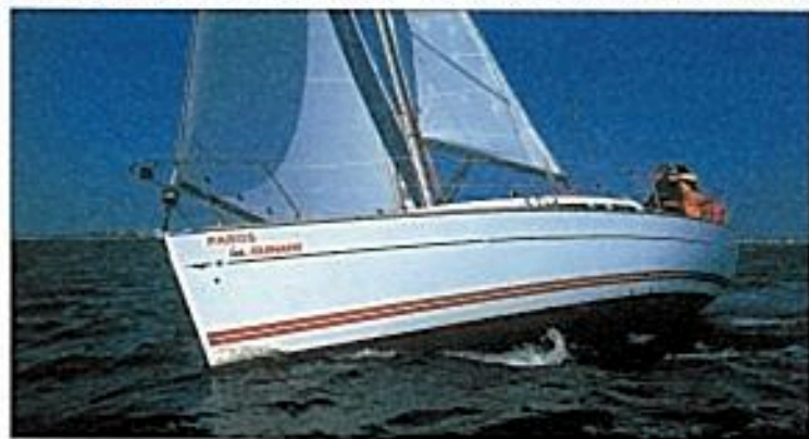
Aplatir les voiles et avancer leur creux: c'est le travail des drisses, de la bordure et du cunningham.
