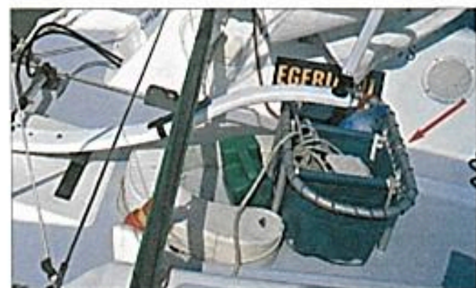
Vu sur un Mini-Transat: un cale-pieds qui fait aussi office de rangement de cockpit. Judicieux!
