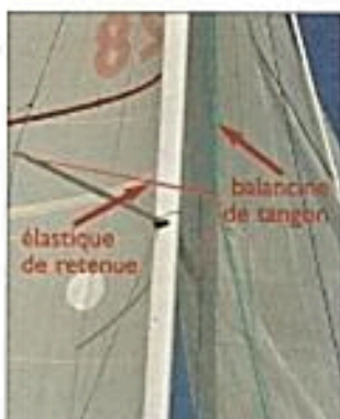
Une balancine toujours à poste.
