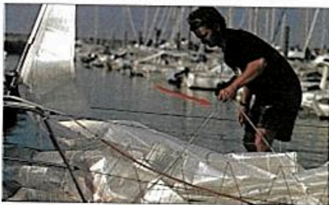
Une pantoire élastique très pratique pour étouffer la voile d'avant.
