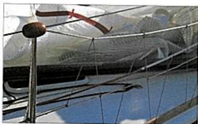
Un transfilage qui ne sollicite pas les filières et une roulette de génois issue du « système D » d'Arnaud Boissières.
