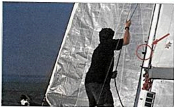
Un coinqueur bien pensé sur le mât, pour interrompre l'envoi d'une voile.
