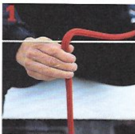
1 Passez le bout de la défense par-dessus le câble de la filière.
