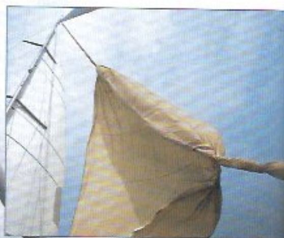
Bordez progressivement. Les brins de laine du milieu craquent en premier, le spi gonfle et se libère dans une réaction en chaîne.
