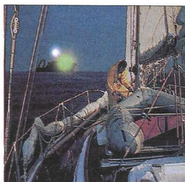
Feux de navire rouges aperçus sur tribord ou verts aperçus sur bâbord, rouge sur vert, vert sur rouge : risque d'abordage.
