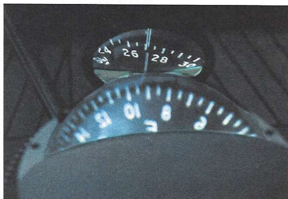
Astucieux, le cap visible de l'avant du compas grâce à un miroir.
