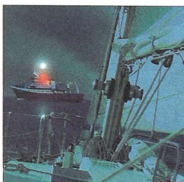
Feux de navire rouges aperçus sur bâbord ou verts aperçus sur tribord, rouge sur rouge, vert sur vert : pas de risque d'abordage.
